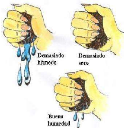
Medición de la Humedad
